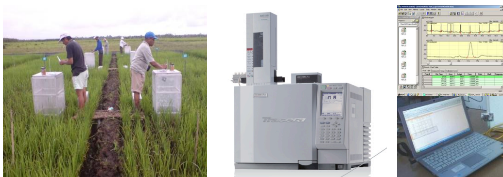
Gambar 6. Pengambilan contoh gas karbon dan pengukuran fluks karbon (CO 2 dan CH 4 ) dengan alat GC model Shimadzu 2010plus
